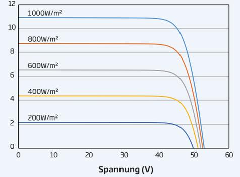
**P-V KURVEN DES PV-MODULS (450 W)**
