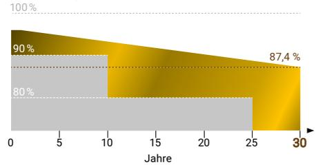
■ Lineare Leistungsgarantie für Glas-Glas Solarmodule
